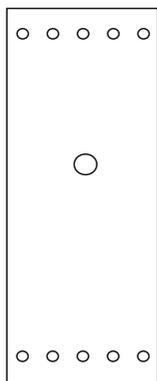
Ширина шага пробойника 4 мм
